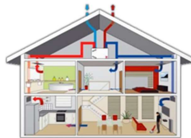
Aanleg balansventilatiesysteem in een woning
